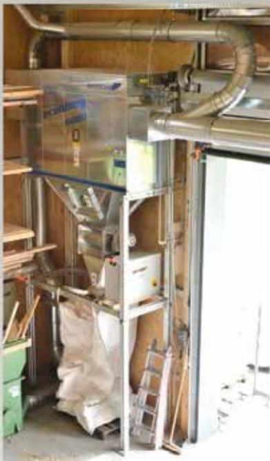
Die Absauganlage mit Zentrifugenschleuse und BigBag-Abfüllung.
