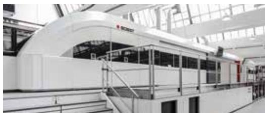
2015 wurde eine Bobst-Digitaldruckmaschine als Beta-Version bei der Model AG in Weinfelden in Betrieb genommen. Seither wurde die Anlage kontinuierlich weiterentwickelt. Kürzlich wurde die Investition in die digitale Stream-Inkjet-Technologie mit dem Einbau des Lackwerkes abgeschlossen.
