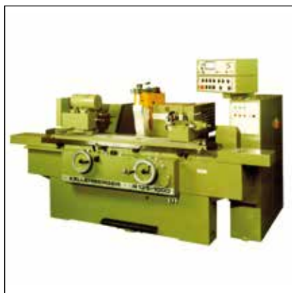
Um 1980 enthält die Maschine bereits einen Schrittmotor für die Zustellung, was ein erster Schritt Richtung CNC war.
