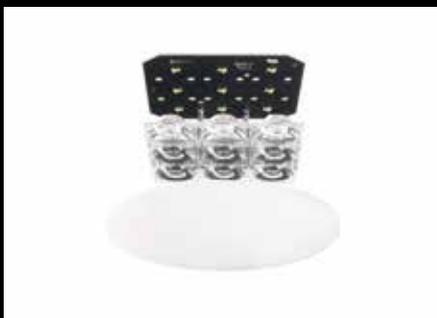
Das eigens von ERCO für LED-Technologie entwickelte Spherolitlinsensystem basiert auf dem Prinzip der Lichtprojektion: Das von den Hochleistungs-LEDs erzeugte Licht wird über einen Kollimator gebündelt und streulichtfrei ausgerichtet. Die darüber platzierte scheibenförmige wechselbare Spherolitlinse sorgt für die spezifische Lichtverteilung.
