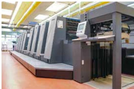
*Heidelberg Speedmaster XL 75, 8-Farben, LE UV mit Wendung (beidseitiges farbiges Bedrucken in einem Durchgang bei voller Geschwindigkeit möglich)*
