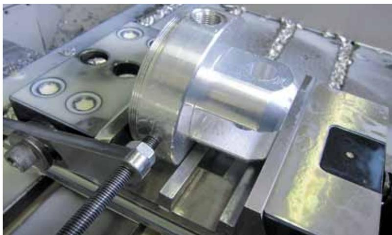
*Gewindeschneiden bei Zylinderboden der Serie Z.*
