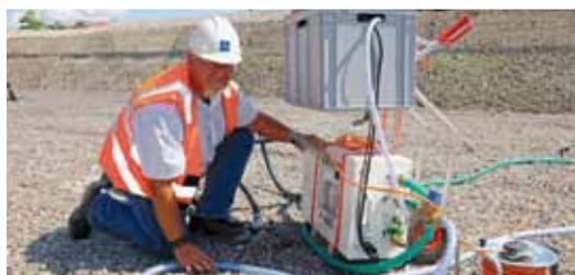
Qualitätsprüfung der Erdwärmesonden mit dem Testgerät DPG-C3 der Fa. Geowatt AG (Quelle: Geotherm AG)
