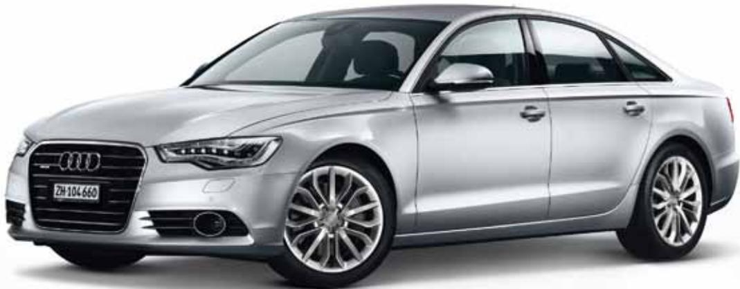
**Der neue Audi A6 in Aluminium-Hybrid-Bauweise** ist um 80 Kilogramm leichter als das Vorgängermodell. Die Leichtbautechnologie aus Aluminium und Stahl minimiert in Kombination mit innovativer Technik den Verbrauch, sorgt für höhere Agilität und maximale Effizienz. Vorausschauende Systeme, wie der Spurhalteassistent active lane assist oder das neue Head-up Display, versichern zusätzlich das Fahrvergnügen.
