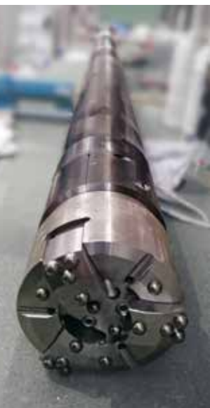
Der kompakte Bohrroboter vereint Antrieb, Elektronik und Bohrtechnik auf engstem Raum.
