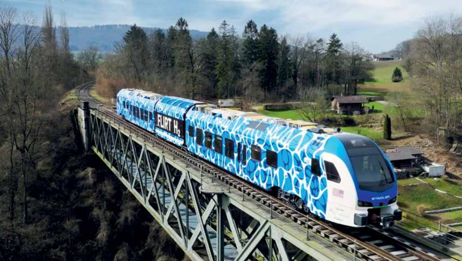
Der Flirt H<sub>2</sub> produziert im «Powerpack» in der Mitte Strom mit einer Brennstoffzelle.
