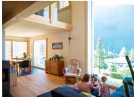
Die Wohnräume werden passiv beheizt durch direkte Sonneneinstrahlung sowie die Abstrahlung von Menschen und Geräten. Die gute Dämmung hält die Wärme zurück.
