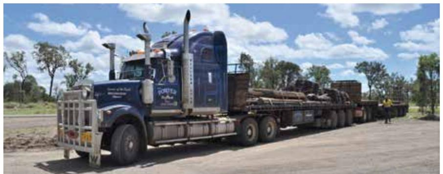
Kurzer Road-Train, rundum mit Dieseltanks für 3000 Liter ausgerüstet.
