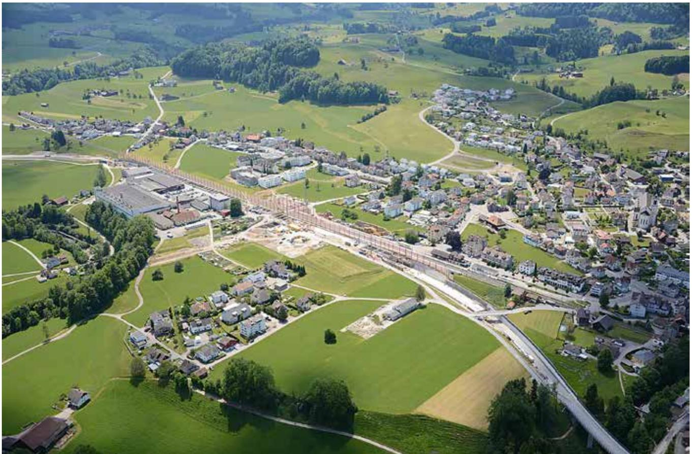
Die Umfahrung Bütschwil ist rund 3,8 Kilometer lang und erstreckt sich vom Anschluss Engi bis zum Anschluss Neudietfurt. Nebst dem Trassebau erstellte das Baudepartement vier Tagbautunnel und drei Brücken mit einer Gesamtlänge von rund 1,5 Kilometern bzw. 200 Metern. Für die Umfahrung wurden 350 000 Kubikmeter Erde ausgehoben, wovon fast die Hälfte wiederverwendet wurde. Weiter kamen 1 700 Bohrpfähle und 90 000 Kubikmeter Beton zum Einsatz.
