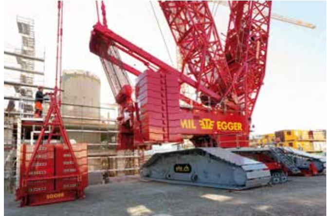
*Erspart zeitaufwendiges Ballastieren und einen Rüstkran: Der VarioTray-Ballast wird gerade an den Derrick-Ausleger gebolzt.*
