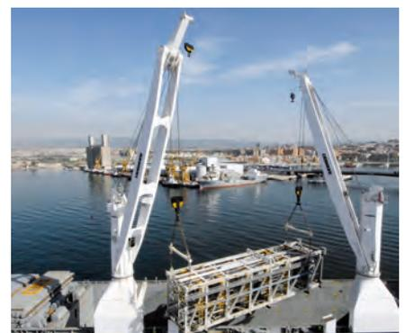
**Liebherr-Schiffskrane beim Bewegen von Lasten im Tandembetrieb**
